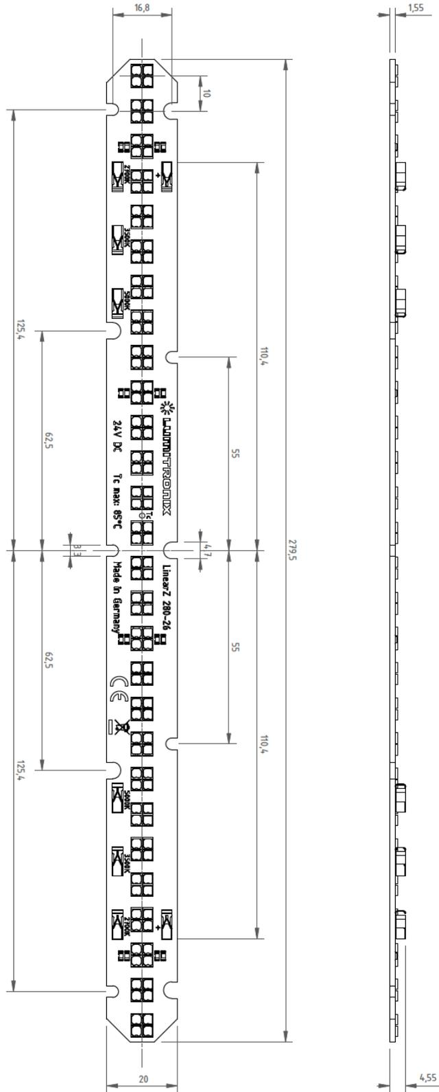
LUMIBARTW-112-4098+ TOSHIBA-SSC TW LED STRIP ZHAGA SUNLIKE CRI98 WHITE 2700K+3500+5000K 990LM 24V 112 LEDS 28CM MODULE
