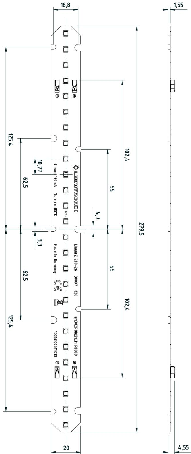
LUMIBAR-26-3098+ NICHIA LED STRIP OPTISOLIS CRI99 PURE WHITE 5000K 752LM 14PPF 175MA 37.5V 26 LEDS 28CM MODULE
